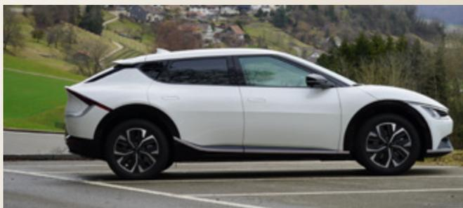
4,68 Meter lang, 2,90 Meter Radstand und hohe Bodenfreiheit.
