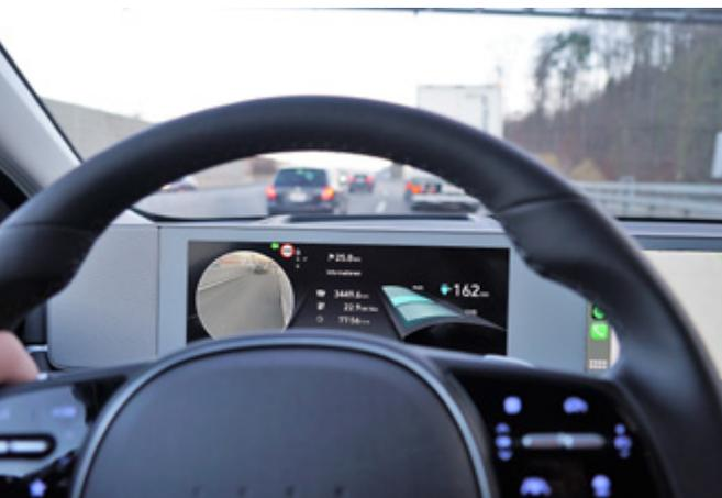
Bei gestelltem Blinker wird die Seitenspiegelkamera aktiviert.
