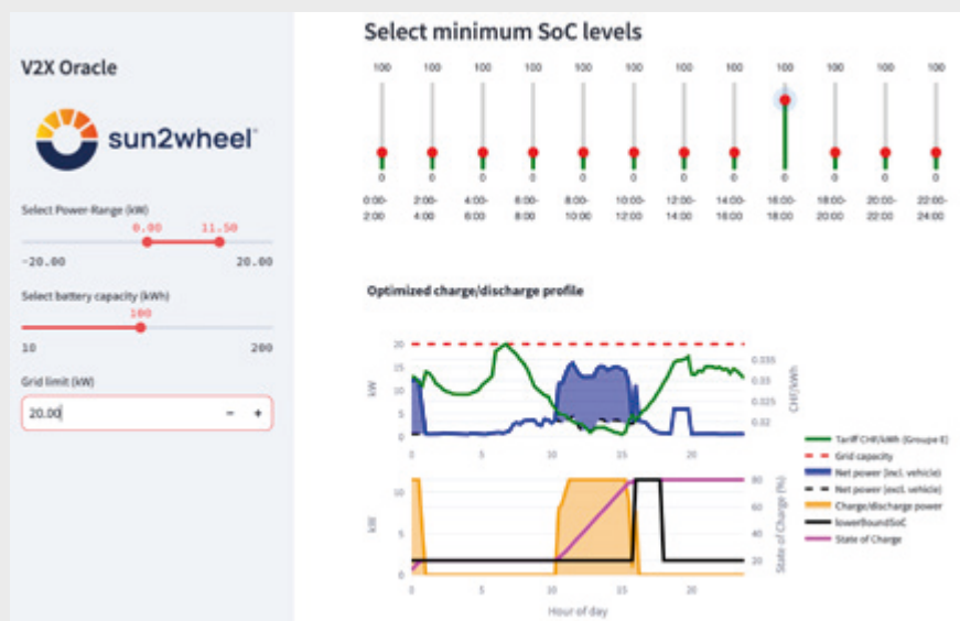
Abbildung 2: Der Pick-up SOC ist zu einer bestimmten Zeit vorgegeben.
