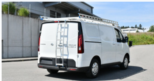
Der neue eDELIVER 7 mit ProTop-RACK-Lastenträger und Hecktürleiter der Walter Rüegg AG
