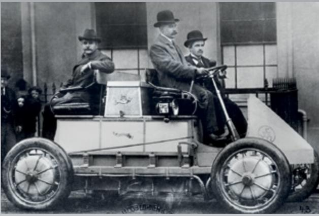
**Alte Idee: Lohner-Porsche aus dem Jahr 1900 mit Radnaben-Elektromotoren und Allradantrieb**
