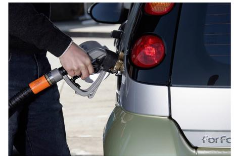
liquide dans des réservoirs sous pression (jusqu'à 16 bar) et refroidi (-120°C à -150°C) afin de minimiser les pertes par évaporation.
