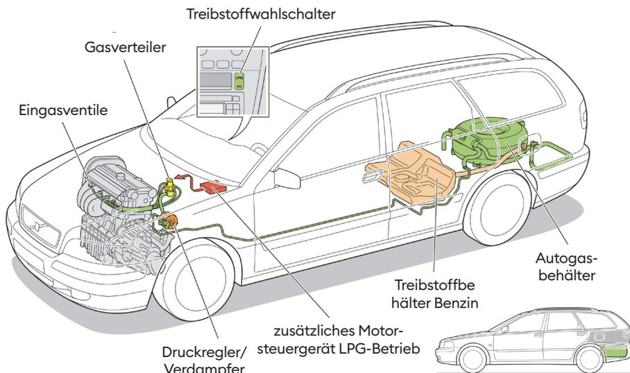
Das Autogas LPG wird an der Tankstelle als Flüssiggas wie Benzin nachgetankt. Die Betankungsdauer ist kurz. Weil drei verschiedene Zapfpistolen in Europa eingesetzt werden, muss je nach Land ein anderer Adapter auf das Gasventil des Fahrzeuges aufgesetzt werden, um die Betankung sicherzustellen. Die Umweltfreundlichkeit ist insofern gegeben, dass LPG hauptsächlich aus Propan und Butan besteht und damit weniger  $CO_2$  emittiert als im Benzinbetrieb.
