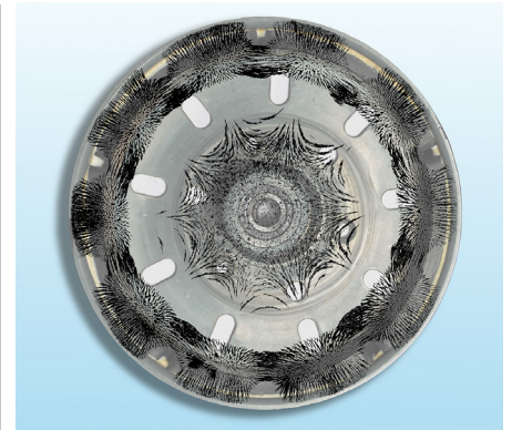
Les lignes de champ magnétique peuvent être rendues visibles avec de la poudre de fer. Si le champ magnétique est trop fort, la poudre de fer est agglomérée et ne forme pas de structure.
