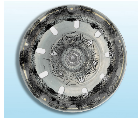
Die magnetischen Feldlinien können mit Eisenpulver sichtbar gemacht werden. Ist das Magnetfeld zu stark, wird das Eisenpulver angesaugt und bildet keine Struktur.
