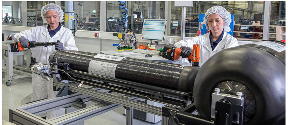
Um H 2 im Fahrzeug zu transportieren, müssen Compound-Gastanks verbaut werden.
