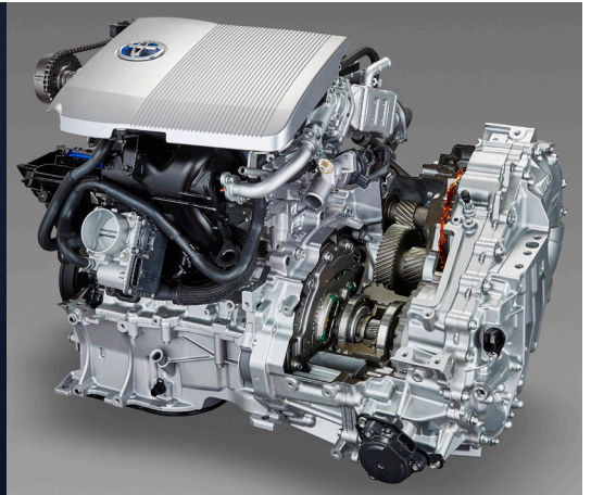
Aperçu de la propulsion hybride avec un moteur à combustion et deux machines électriques
