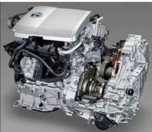
Panoramica della trazione ibrida con un motore a combustione interna e due macchine elettriche
