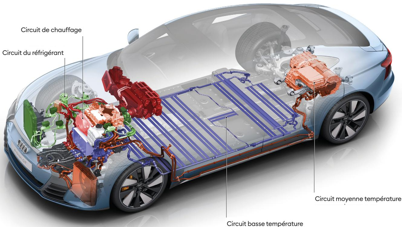
La batterie HV est refroidie dans le circuit basse température. Le chauffage se fait à l'aide d'une résistance PTC et le refroidissement se fait via la climatisation et un refroidisseur.
