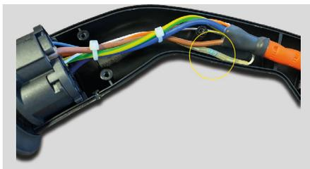
Fig 2 : Résistance entre PP et PE.
