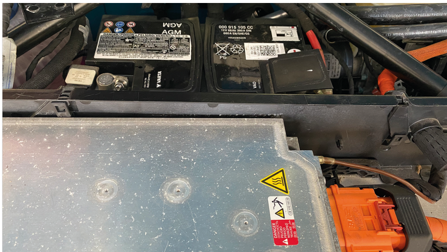
Fig. 1 : L'Audi e-tron s'appuie sur une grosse batterie AGM pour le réseau de bord 12 V.
