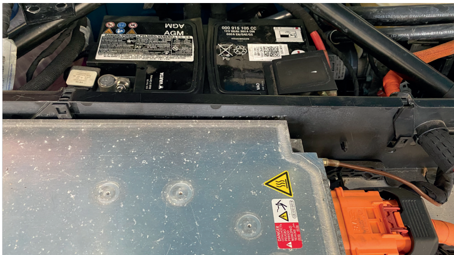
Bild 1: Der Audi e-tron vertraut auf eine grosse AGM-Batterie für das 12-V-Bordnetz.
