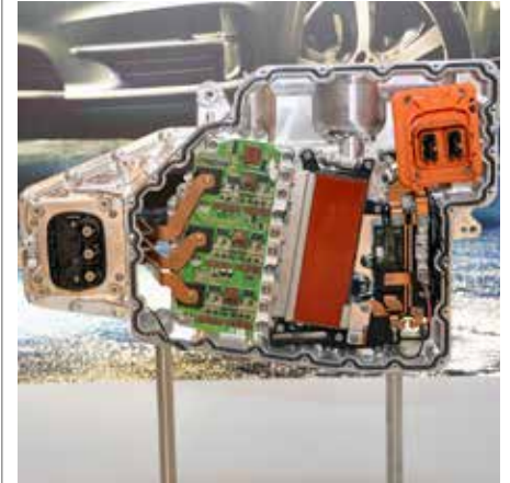
L'elettronica di potenza della BMW X5 gestisce una gamma di tensione di 240 - 410 V e una corrente di fase massima di 450 A.
