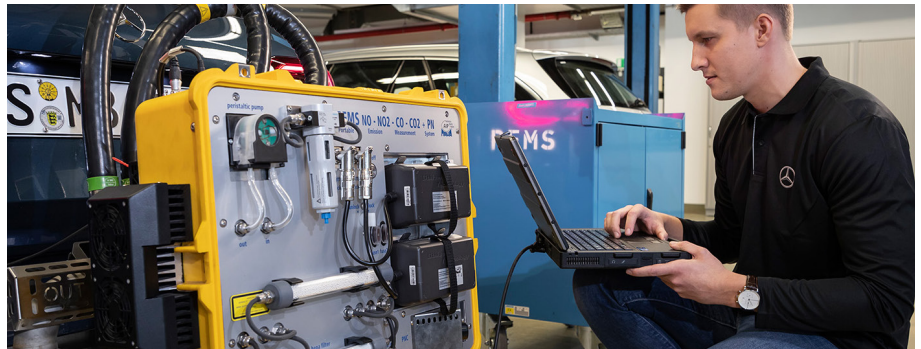
Le emissioni stradali vengono registrate con un sistema di misurazione delle emissioni portatile (PEMS).
