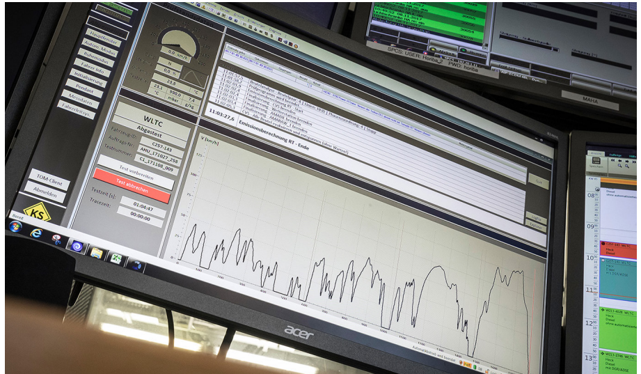
Nella misurazione al banco di prova, i veicoli viaggiano secondo il ciclo WLTP. Le fasi di arresto visibili, sono motivate dall'implementazione del sistema start-stop (mild hybrid). Più basso è il consumo di carburante del motore a combustione, minori sono le emissioni di CO 2 .
