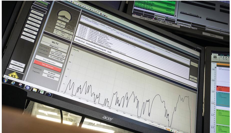
Lors des mesures au banc d'essai, les véhicules sont déplacés selon le cycle WLTP. Les phases d'arrêt sont une motivation pour intégrer un système start-stop (mild hybrid). Plus la consommation du moteur thermique est faible, plus les émissions de CO<sub>2</sub> sont faibles selon la norme.
