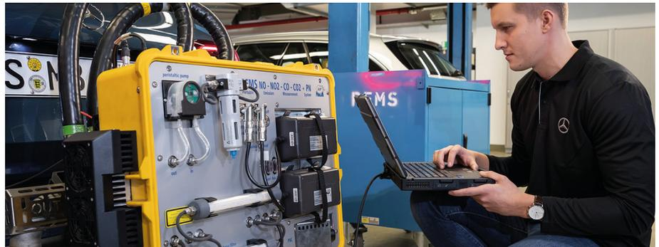
Les émissions routières sont enregistrées à l'aide d'un appareil portable de mesure des émissions (PEMS).
