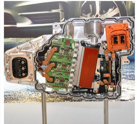
L'électronique de puissance du BMW X5 traite une plage de tension allant de 240 à 410 V et un courant de phase maximal de 450 A.
