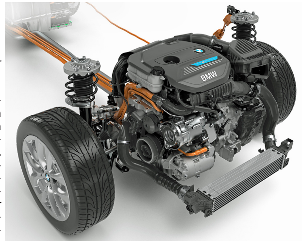
Vorderradantriebseinheit mit Starter-Generator und Klimakompressor.
