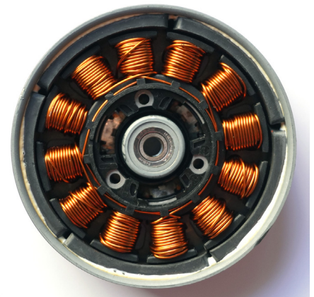
Moteur sans balais d'un ventilateur de radiateur. Dans le moteur sans balais, les 12 bobines individuelles sont commandées par groupes de quatre par des transistors. Puisqu'il s'agit d'un rotor externe, le rotor est en forme de tambour et les cinq aimants permanents sont collés à l'intérieur du tambour. Ils sont également sollicités par les forces centrifuges.
