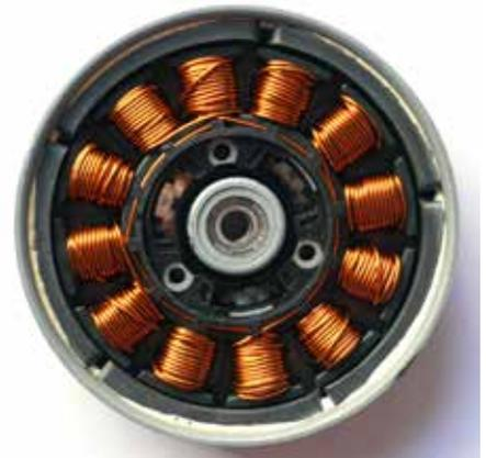
Il motore brushless di una ventola del radiatore. Nel motore brushless, le 12 bobine individuali sono controllate a gruppi di quattro da transistor. Trattandosi di un rotore esterno, esso è a forma di tamburo ed i cinque magneti permanenti sono incollati all'interno dello stesso e pressati grazie all'effetto della forza centrifuga.
