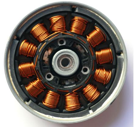
Der Brushless-Motor eines Kühlventilators. Beim bürstenlosen Motor werden die 12 Einzelspulen in Vierergruppen von Transistoren angesteuert. Da es sich um einen Aussenläufer handelt, ist der Rotor trommelförmig gestaltet und die fünf Permanentmagnete werden innen an die Trommel geklebt. Durch die Fliehkräfte werden sie zusätzlich angepresst.
