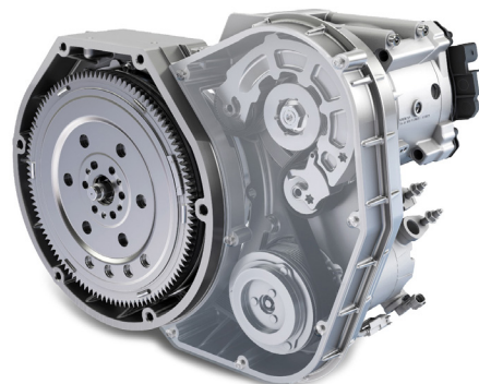
Bild 3: Eine achsparallele 48-Volt-Lösung von Continental. Der Riemen treibt ebenfalls den Klimakompressor an.
