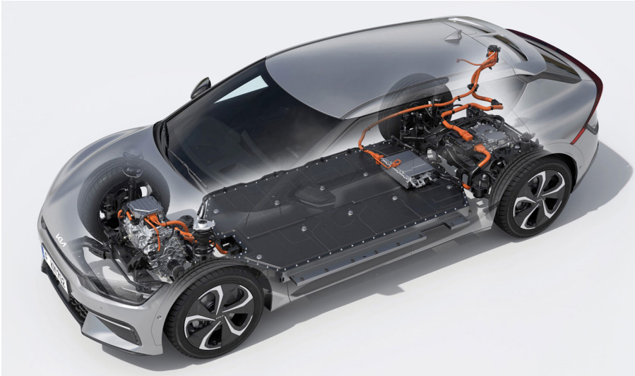
Fig. 1: la Kia EV6 a propulsione elettrica è disponibile con trazione posteriore o integrale.
