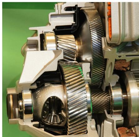
Fig. 3: Miba, utilizza il rotore (in basso a destra) per azionare un grande ingranaggio cilindrico tramite un pignone, per il secondo rapporto.
