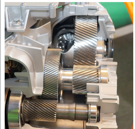
Fig 4 : Chez Magna également, le deuxième étage d'engrenage est constitué par des engrenages cylindriques nettement plus larges.
