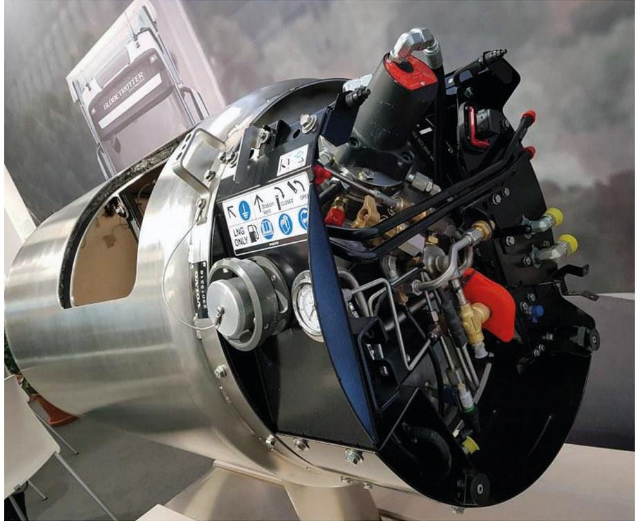
Les réservoirs de gaz GNL sont isolés thermiquement de manière optimale afin que le gaz liquide froid puisse absorber le moins d'énergie thermique possible de l'environnement. La tuyauterie est complexe.
