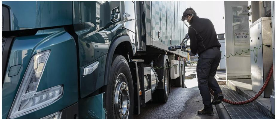
Contrairement aux véhicules GNC, le gaz est rempli très froid ( $-160^{\circ}\text{C}$ ) et est donc liquide. Le ravitailleur doit s'habiller pour se protéger personnellement contre les brûlures par le froid.
