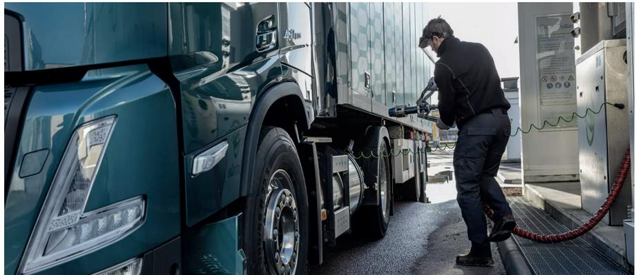
A differenza dei veicoli CNG, il gas viene rifornito molto freddo ( $-160^{\circ}\text{C}$ ) e quindi in forma liquida. Gli operatori devono equipaggiarsi in modo corretto, per proteggersi dalle ustioni da freddo.
