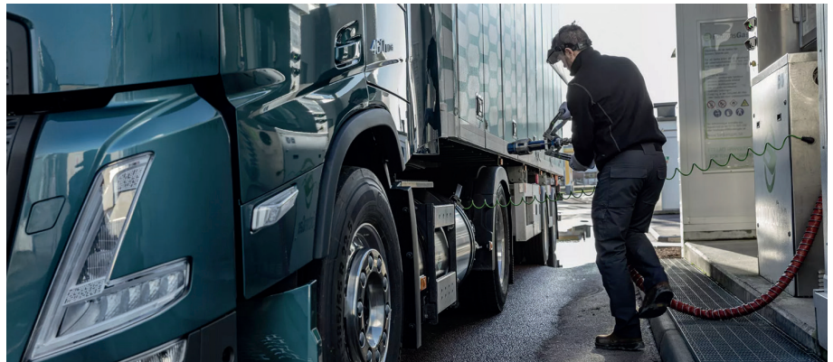
Im Gegensatz zu CNG-Fahrzeugen wird das Gas sehr kalt ( -160^{\circ}\text{C} ) und damit flüssig betankt. Der Betanker muss sich zum persönlichen Schutz vor Kälteverbrennungen einkleiden.
