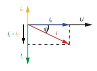
Im Zeigerdiagramm hat der Strom des ohmschen Widerstandes  $I_{\rm R}$  die gleiche Phase wie die Spannung. Mit ihm und aus der Differenz von  $I_{\rm C}$  und  $I_{\rm L}$  kann der Strom / bestimmt werden. Der Winkel  $\varphi$  wird Phasenverschiebungswinkel genannt.
