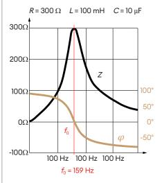
Das Beispiel zeigt den Verlauf des Scheinwiderstandes Z und des Phasenverschiebungswinkels  $\varphi$ , abhängig von der Frequenz. Die Werte gelten bei R = 300  $\Omega$ , L = 100 mH und C = 10  $\mu$ F.
