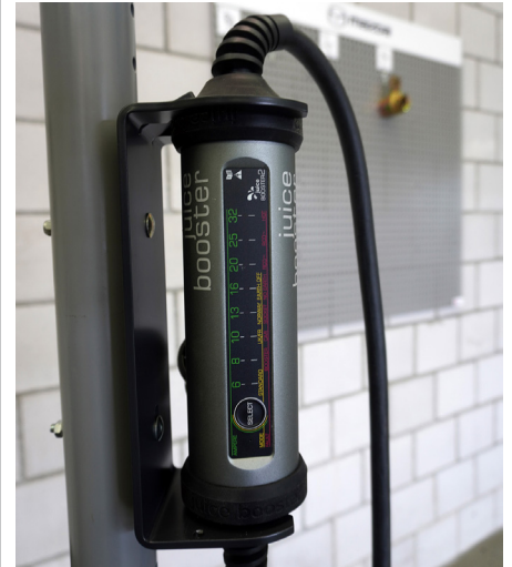
Fig 1 : Lors de la charge des véhicules électriques, des transformateurs fonctionnant avec une énergie du secteur sinusoïdale sont utilisés. La photo montre une boîte murale fabriquée en Suisse.
