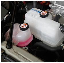
La couleur du fluide différencie les circuits : Chez Toyota, le liquide de refroidissement des composants HV est coloré en rose et le liquide de refroidissement spécial pour la partie pile à combustible est clair et transparent. Si le liquide de refroidissement FC est mélangé avec d'autres liquides ou avec de l'eau, seul un rinçage coûteux et long du système sera efficace.
