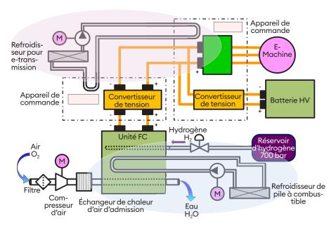
La gestion thermique d'un véhicule à pile à combustible se compose d'au moins deux parties. Les composants du système hauts voltages et la pile à combustible. Ils sont refroidis séparément.
