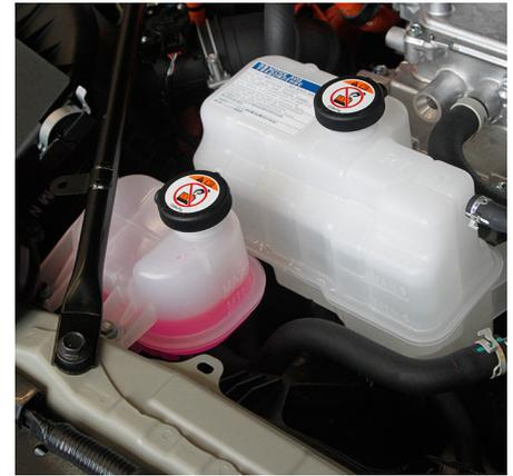
Die Farbe des Thermofluids verrät die Kreise: Pink eingefärbt ist bei Toyota die Kühlflüssigkeit für die HV-Komponenten und klar und durchsichtig die spezielle Kühlflüssigkeit für den Brennstoffzelle. Wenn die FC-Kühlflüssigkeit vermischt wird mit anderen Flüssigkeiten oder mit Wasser, hilft nur eine teure und aufwändige Spülung des Systems.
