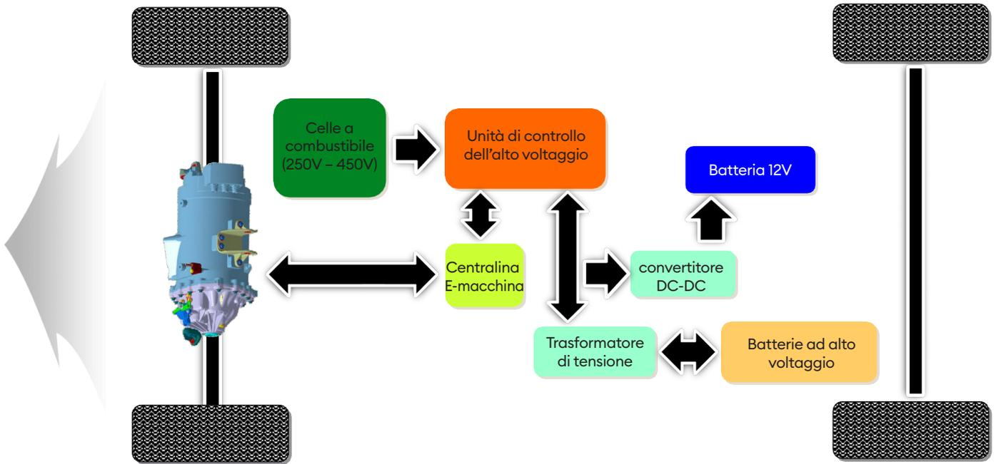
La cella a combustibile fornisce energia elettrica alla E-macchina, alla batteria da 12 Volt tramite il convertitore DC-DC e alla batteria ad alto voltaggio (stoccaggio intermedio). Durante i transitori (accelerazione), la E-macchina riceve energia dalla FC e dalla batteria ad alto voltaggio.
