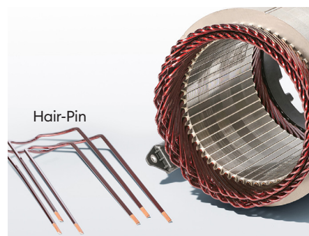
Fig. 2: al posto dei fili a sezione circolare, nell'avvolgimento Hair-Pin (a forcina) vengono inserite parti in rame prefabbricate a sezione rettangolare.
