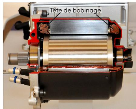
Fig. 1 : Les enroulements ondulés sont traditionnellement construits avec de nombreuses spires de fils de cuivre à section ronde.
