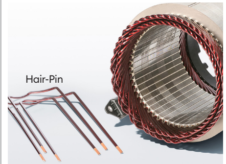
Bild 2: Anstelle von Drähten mit rundem Querschnitt, werden bei der Hair-Pin-Wicklung vorgefertigte Kupferteile mit rechteckförmigem Querschnitt eingefügt.
