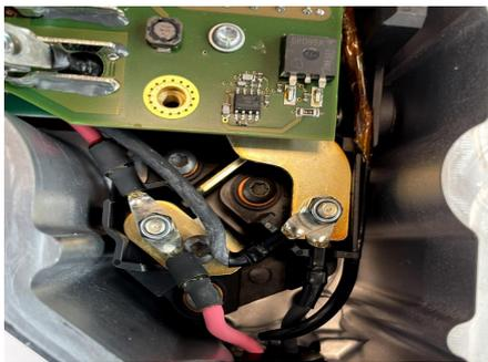
Fig. 2: alimentazione della centralina
