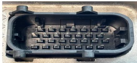
Fig. 3 : Connecteurs pour les signaux d'entrée
