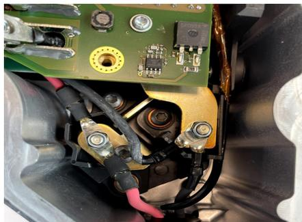
Bild 2: Spannungsversorgung Steuergerät
