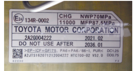
Die teuren Composit-Tanks haben eine begrenzte Lebensdauer und müssen nach Ablauf der Lebensdauer gewechselt werden.
