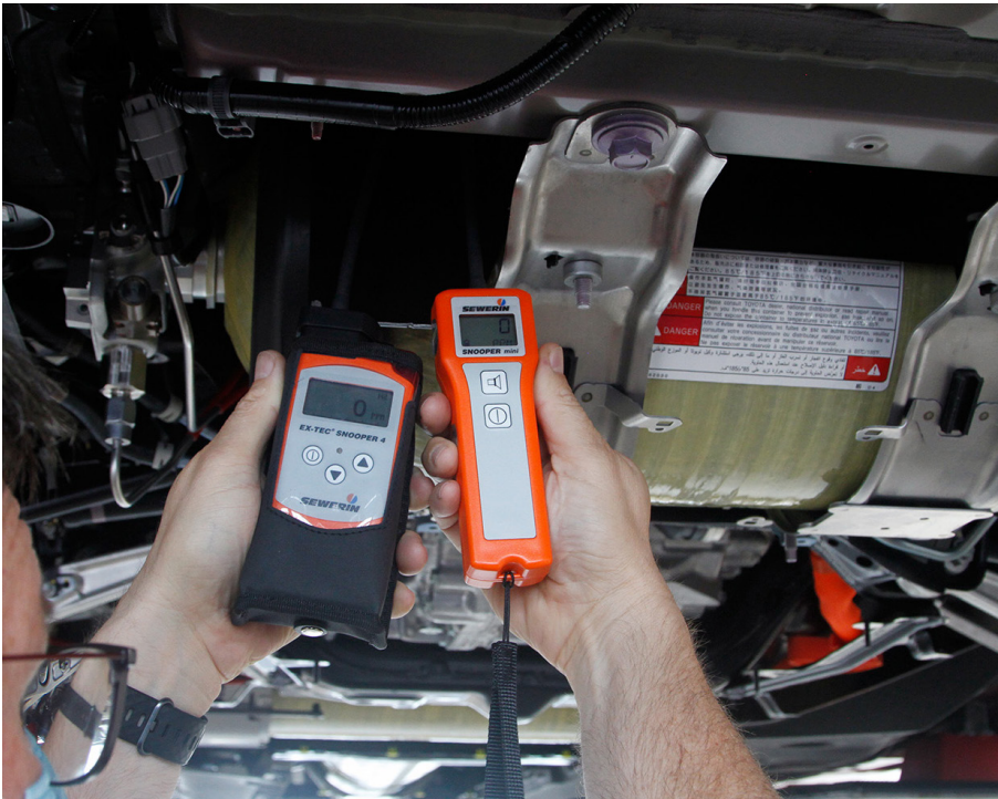
Bei der Wartung eines Brennstoffzellenfahrzeuges ist die Überprüfung der Dichtheit des Wasserstoffsystems wichtig. Mit Wasserstoffschnüfflern wird auch ein kleinstes Leck detektiert.
