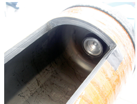
Die Composit-Tanks weisen einen Schichtaufbau auf und speichern bis zu 700 bar Druck.
