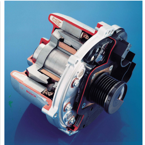
Fig. 1: il noto alternatore è un trasformatore di energia che converte parte dell'energia meccanica dell'albero motore in energia elettrica, fornendo la tensione alla rete di bordo del veicolo.
