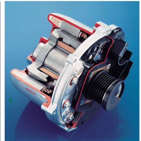
Bild 1: Der bekannte Alternator ist ein Energiewandler, der einen Teil der mechanischen Kurbelwellenenergie in elektrische Energie umwandelt, womit das Bordnetz des Fahrzeugs mit Spannung versorgt wird.
