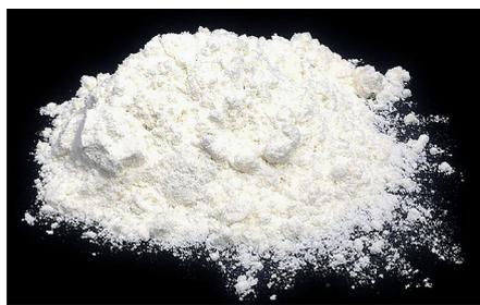
L'hexafluorophosphate de lithium ( $LiPF_6$ ) est une poudre blanche utilisée comme sel conducteur dans la plupart des électrolytes des batteries au lithium.
