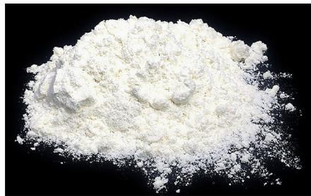
Lithiumhexafluorophosphat ( $\text{LiPF}_6$ ) ist ein weisses Pulver, das als Leitsalz in den meisten Elektrolyten von Lithium-Batterien verwendet wird.
