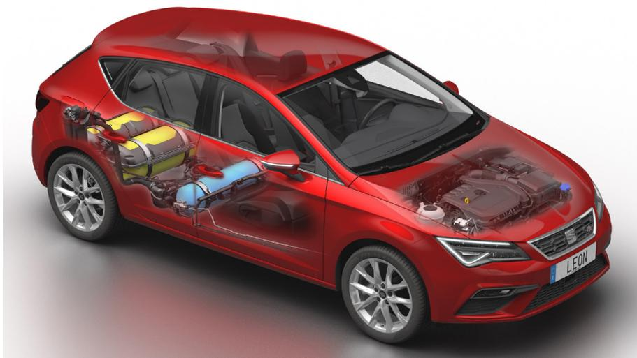
La position d'installation des réservoirs de GNC est choisie de manière à garantir la sécurité en cas de collision (sécurité passive) et à utiliser l'espace d'installation disponible du véhicule.
