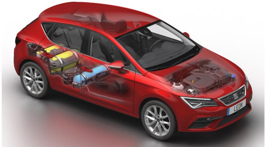
Die Einbaulage der CNG-Tanks wird so gewählt, dass die Crashesicherheit (passive Sicherheit) gewährleistet ist und der vorhandene Bauraum des Fahrzeuges genutzt werden kann.
