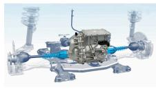
Une machine asynchrone entraîne les roues avant.
