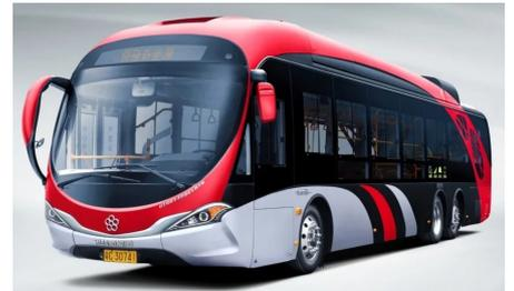
Il Dolphin di Yinlong è dotato di una batteria LTO con una capacità che arriva fino a 150 kWh. Secondo il produttore, la batteria può essere caricata in 20 minuti e raggiungere anche 30'000 cicli.
